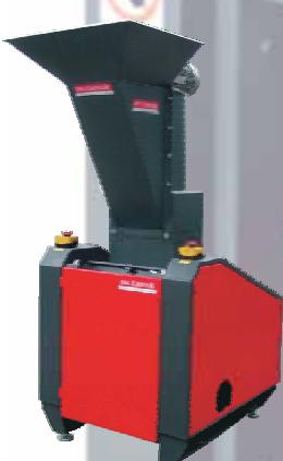
Násypka s nútenským vertikálnym pohybom uľahčuje drvenie ľahkých predmetov a predmetov, ktorých tvar komplikuje ich vstup medzi nože mlyna
