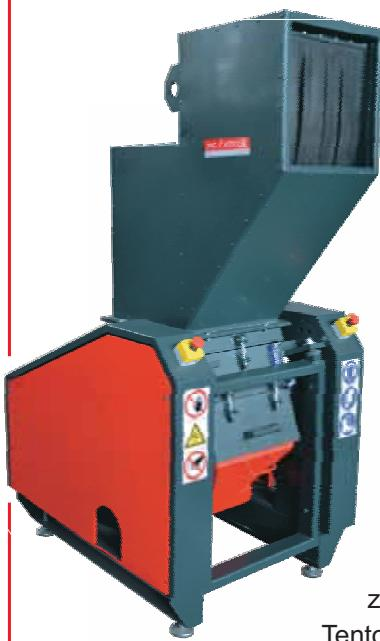
K drveniu materiálu v nožovom mlyne dochádza na priamkovom ostrí pracovných nástrojov, ktoré sa nachádzajú na rotore a statore stroja. Na definovanie veľkosti požadovanej frakcie výstupu z drviaceho zariadenia slúži sito pod obežnou dráhou rotora. Otvory sita môžu mať priemer 8, 10, 12 alebo 15 mm, podľa špecifikácie zákazníka.
