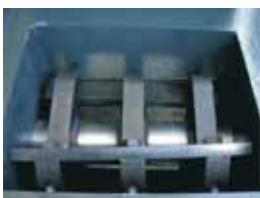
Nože na rotore a v statore driacej komory sú vzájomne šikmo uložené, čo vytvára nožnicový efekt
