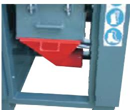
Výsypka pripravená na pripojenie pneumatickej dopravy drviny
